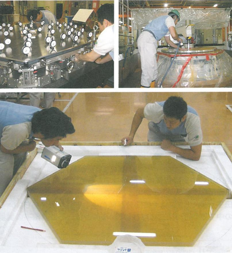
面を実現するため、主鏡中心からの距離に応じて、異なる形状に磨く必要がある。しかも1枚の鏡の中でも主鏡の円周方向と、それと直交する方向では曲率が違う。鏡の縁の部分は磨くのが難しいが、一枚鏡の望遠鏡の場合は縁の部分を集光に用いなければ、それで済む。しかし、複合鏡の場合はそうはいかない。各鏡の縁の部分も含めてきれいな形に整えなければ、多数枚の鏡を組み合わせた時、全体として理想の曲面が実現しない。つまりTMTの鏡を磨くには非常に高度な技術が必要で、そうした技術を用いて、差し渡し1.5mという大きな鏡を、予備品を含めて600枚近く短期間に磨けるメーカーは世界でも限られる。
